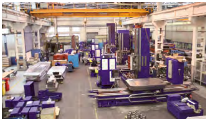
Цех сборки горизонтально-расточных станков напольного типа
