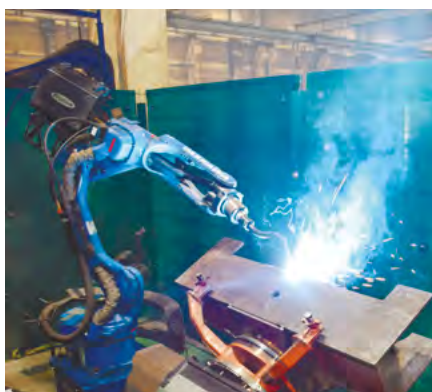
Сварка узлов полурам в сварочном цехе и сварка подмоторной полурамы
