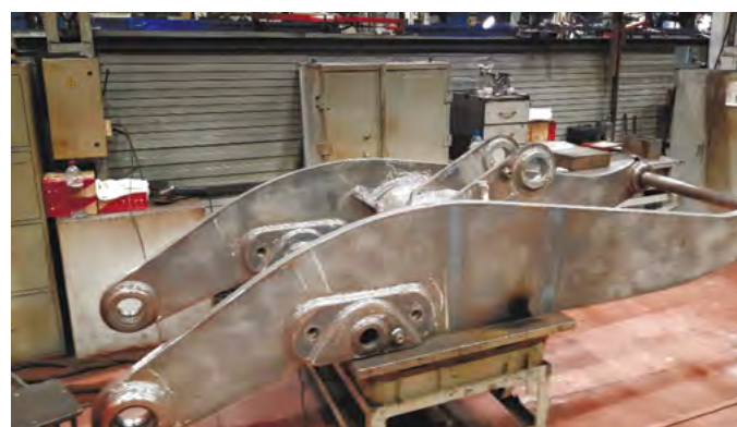
Сварка стрелы и ковша на участке изготовления рабочего оборудования
