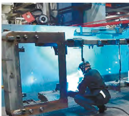
Сварка узлов полурам в сварочном цехе и сварка подмоторной полурамы
