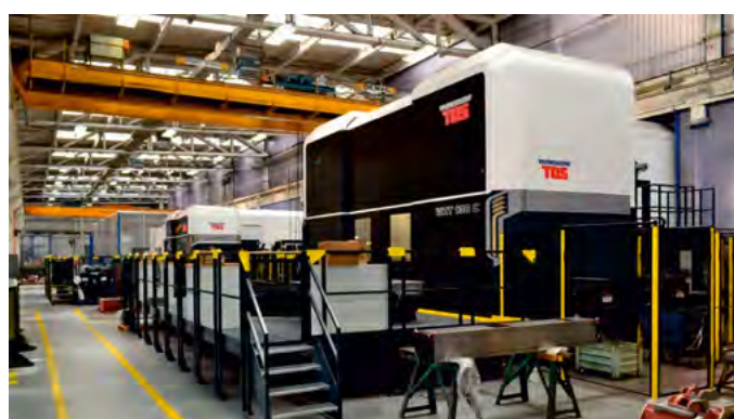
Новый горизонтально-расточный ОЦ WHT 130C
