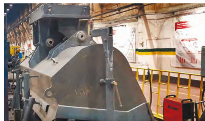
Сварка стрелы и ковша на участке изготовления рабочего оборудования
