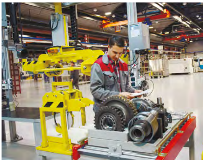
Цех механообработки и производства трансмиссий. КПП собирается на самодвижущейся оснастке
