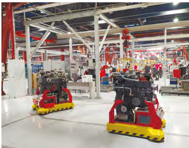
Цех механообработки и производства трансмиссий. КПП собирается на самодвижущейся оснастке
