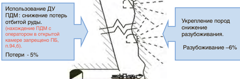
Рис. 3 Синергетический эффект отработки высоких камер с использованием ДУ ПДМ и тросоинъекционного упрочнения пород (в камерах, предусмотренных для размещения РАО 2-го и 3-го классов)
