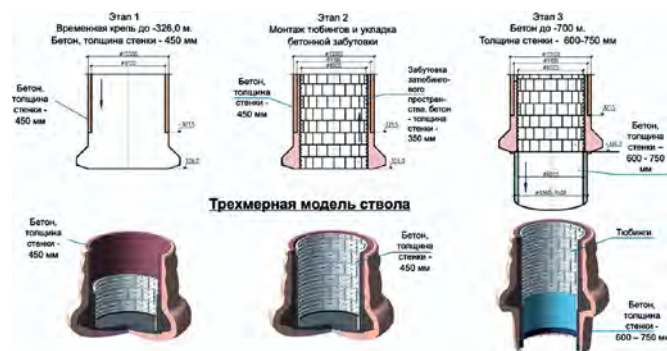
Рис. 8 Последовательность возведения крепи шахтного ствола
