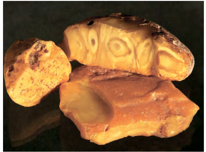
Рис. 3 Непрозрачный янтарь (костяной и пенный), в котором количество пустоток может достигать 900 000 на 1 мм 3
