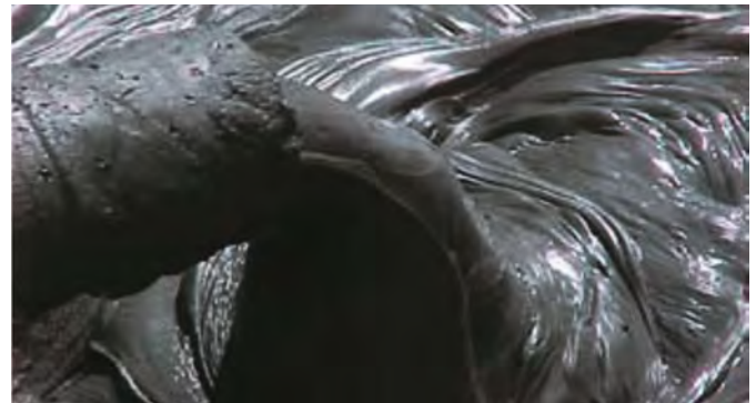
Рис. 5 Транспортировка пастовой закладки с содержанием твердого 45–65%
