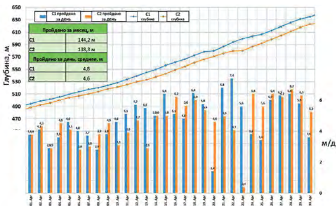
Рис. 20 Рекордные темпы проходки стволов в апреле 2020 г. (144 м/мес. – ствол №1, 138 м/мес. – ствол №2)
