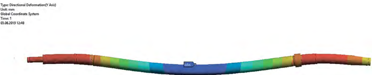
Рис. 3 Расчет динамики собственных частот ротора
