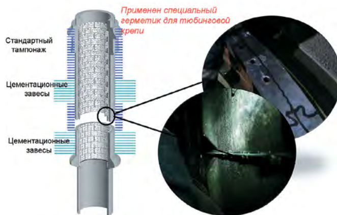
Рис. 13 Схема гидроизоляции шахтного ствола
