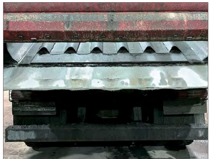
В хвостовой части кузова видно, что откидная нижняя часть заднего борта стёрлась до дыр. За год работы из 12 мм основного пола кузова осталось 7 мм.
