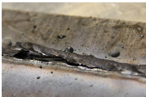
Самоотделение шлаковой корки. Подтверждаем — шлак действительно отделяется легко
