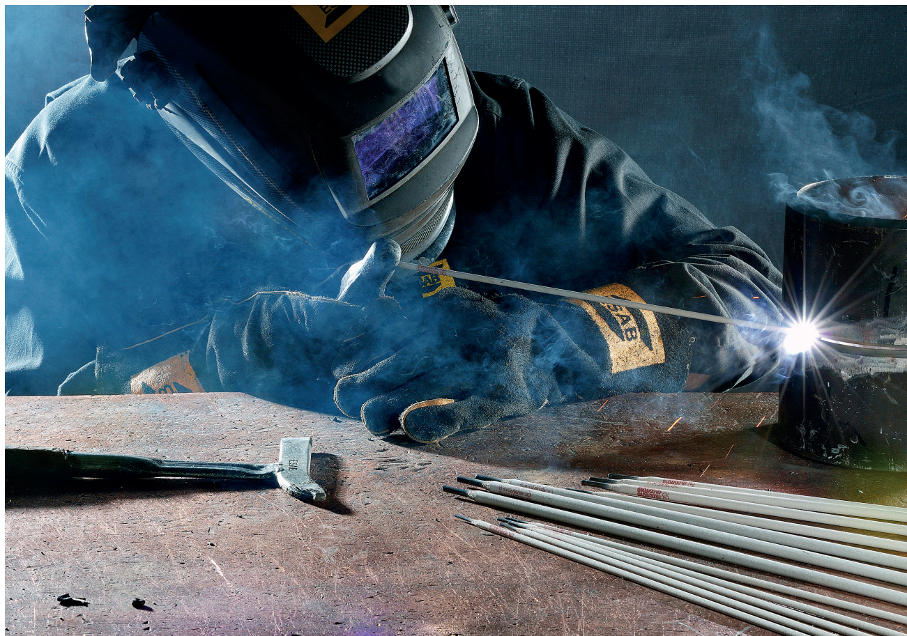
Рис. 2. Сварка штучным электродом
