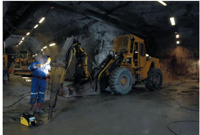
В случае интенсивного абразивного износа на первый план выходят твердость наплавленного металла, наличие, размер и тип твердой фазы – карбидов. К наиболее износостойким покрытиям от этого вида износа относятся те, что содержат элементы вольфрама. Однако стоимость вольфрама растет, и многие предпочитают использовать более доступные материалы на железной основе с включениями карбидов хрома и боридов с твердостью наплавленного слоя 55–70 HRC.
