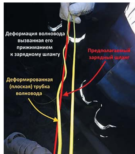
Рис. 3 Внешний вид части волновода со следами воздействия
