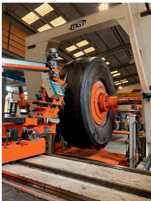
Рис. 3 Наложение протектора навивкой узкой лентой резиновой смеси методом «Orbitread»
