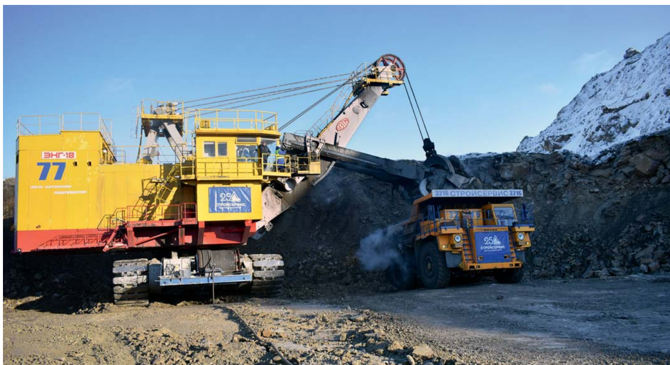
Рис. 6 Экскаватор ЭКГ-18 №13 с ковшом вместимостью 20 м³ (SAE 2:1) в забое с погрузкой в автосамосвалы 130 т на разрезе ООО «СП Барзасское товарищество» ЗАО «Стройсервис»
