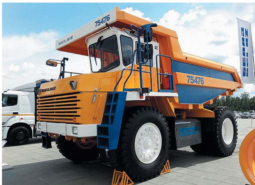
БЕЛАЗ-75476 грузоподъемностью 45 т с газопоршневым двигателем КУНГУР-550
