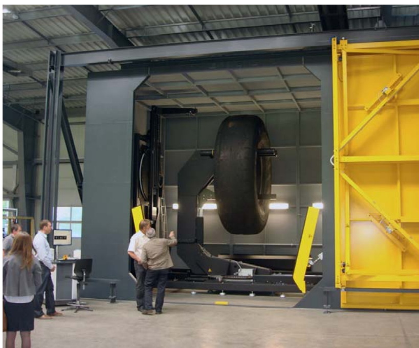
Рис. 4 Установка для вакуумной широкографии КГШ и СКГШ в условиях производства ООО «Поволжская шинная компания» (Тольятти, Самарская обл.)
